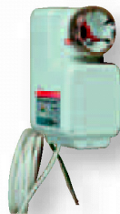
Ventiilijam 3-tee ventiilile Art. Nr. 56234 Ühendatakse otse 3-tee ventiili külge ja juhitakse agregaadi automaatikakilbi kaudu. Juhtpinge: 0-10V Tööpinge: 24V
